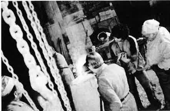
右 ゼラチン型による蠟原形製作 中 焼成が終了したフォルム 左 鑄こみ 中央がニッチ氏
